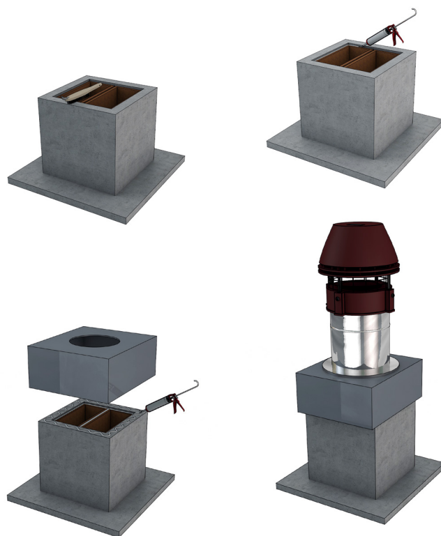
Figure 32 : Préparation des conduits avant pose du plenum et de l'extracteur (cas dalle non conservée)
